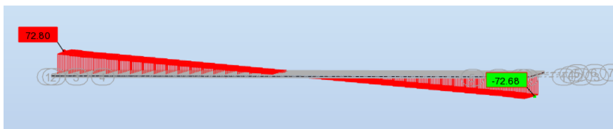
Figure V.21 : Diagramme de l'effort tranchant sous la combinaison la plus défavorable à l'ELS
