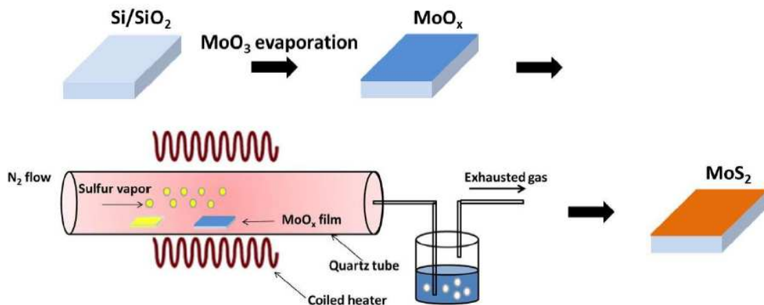
Figure III.14 : Illustration d'un schéma de synthèses d'une couche mince par la sulfuration de MoO x via la méthode CVD. [37]
