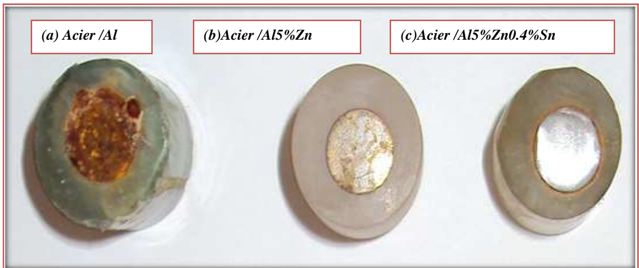
Figure IV. 24 Photographies des électrodes d'acier (cathodes) après essais de couplage galvanique dans la solution de NaCl à 3% en poids.
