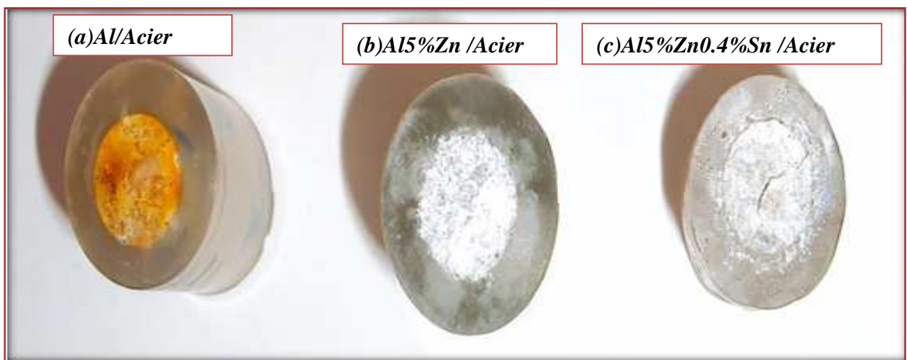
Figure. IV. 25 Photographies de l'anode d'aluminium et ses alliages après 2 mois de couplage à l'acier dans une solution à 3% de NaCl.
