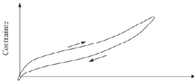
Figure II. 18 : Courbe d'hystérésis d'un élastomère [8].
