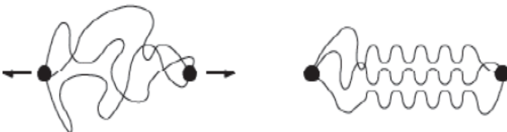
Figure II. 16 : Cristallisation sous contrainte [14].
