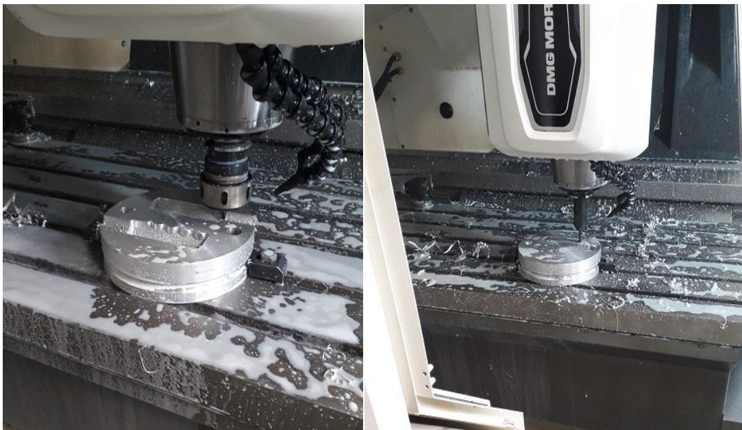
Figure IV. 20 : Usinage du moule dans la MOCN.
