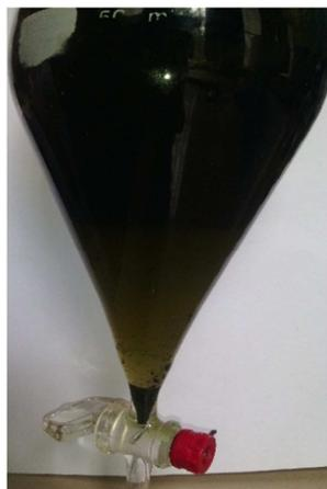
**Figure 16:** Séparation de la spiruline de l'huile usagée au moyen d'une ampoule à décanter.
