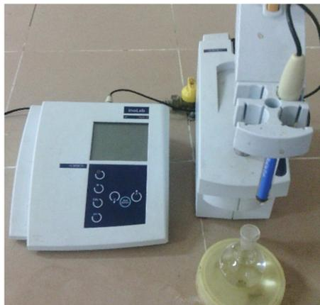
**Figure 24:** photo du pH mètre de type (Inolab).
