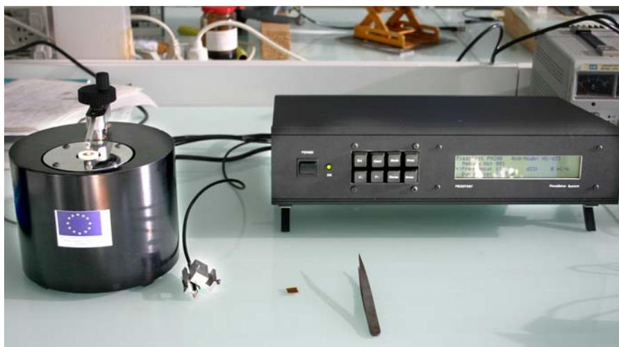
**Figure 6 : Piézomètre (Piezotest PM200)**
