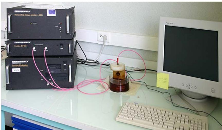
**Figure 5 : Photo de l'appareil de mesures des propriétés ferroélectriques Radiant, Precision HV Amplifier  $\pm 4000V$**
