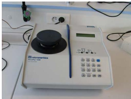
**Figure 2: Pycnomètre à hélium Accupyc 1330**
