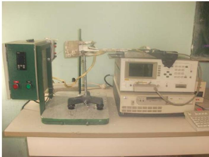
**Figure 5 : Photo de l'appareil de mesures des propriétés diélectriques.**
