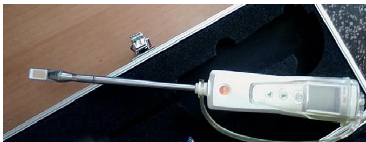
Figure 14. Le friteste « testo 270 » (photo originale)
