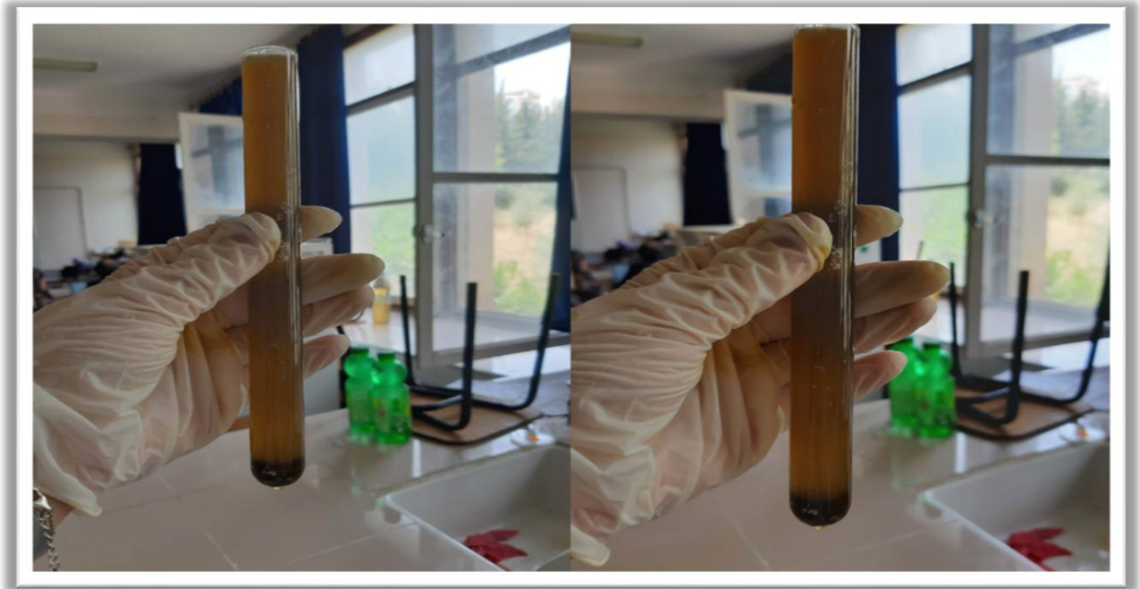
Figure 24 : Méthode de sédimentation (Gada & Frahi, 2021).
