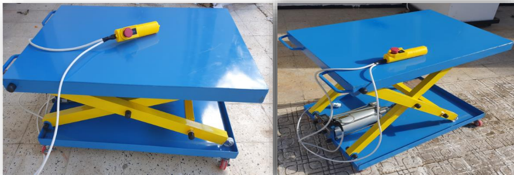
Figure III.1 : Table élévatrice mobile réalisée au hall de technologie Oued Aissi
