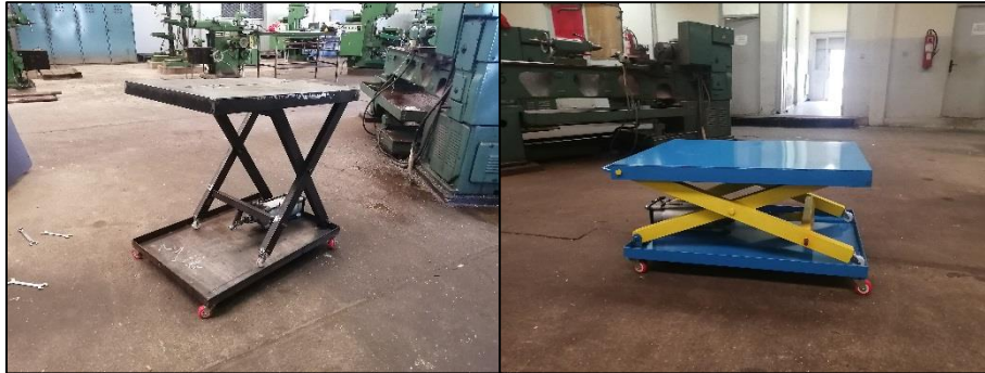
Figure III.26 : Table conçue et réalisée avant et après peinture
