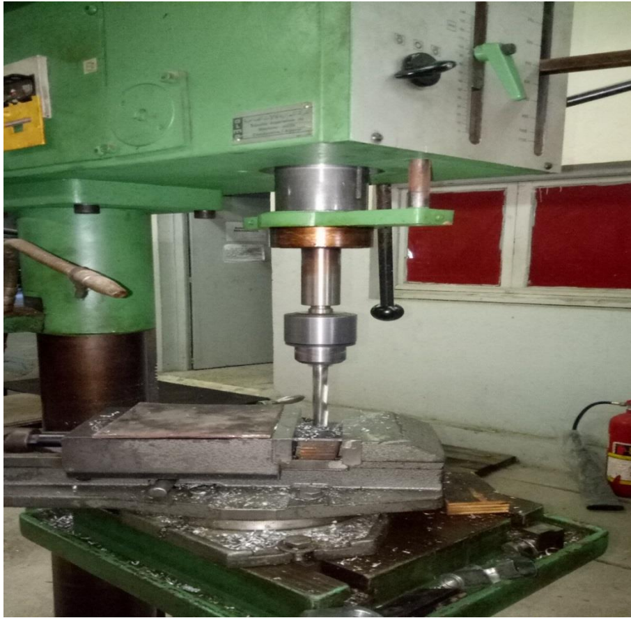
Figure III.23 : Procédé de perçage réalisé au hall de technologie Oued Aissi
