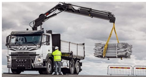
Figure I.22 : Grue de chargement
