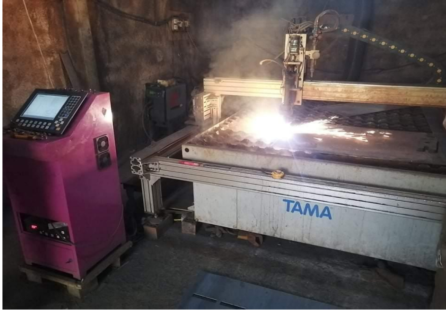
Figure III.19 : Découpeuse plasma «photo prise dans l’atelier »
