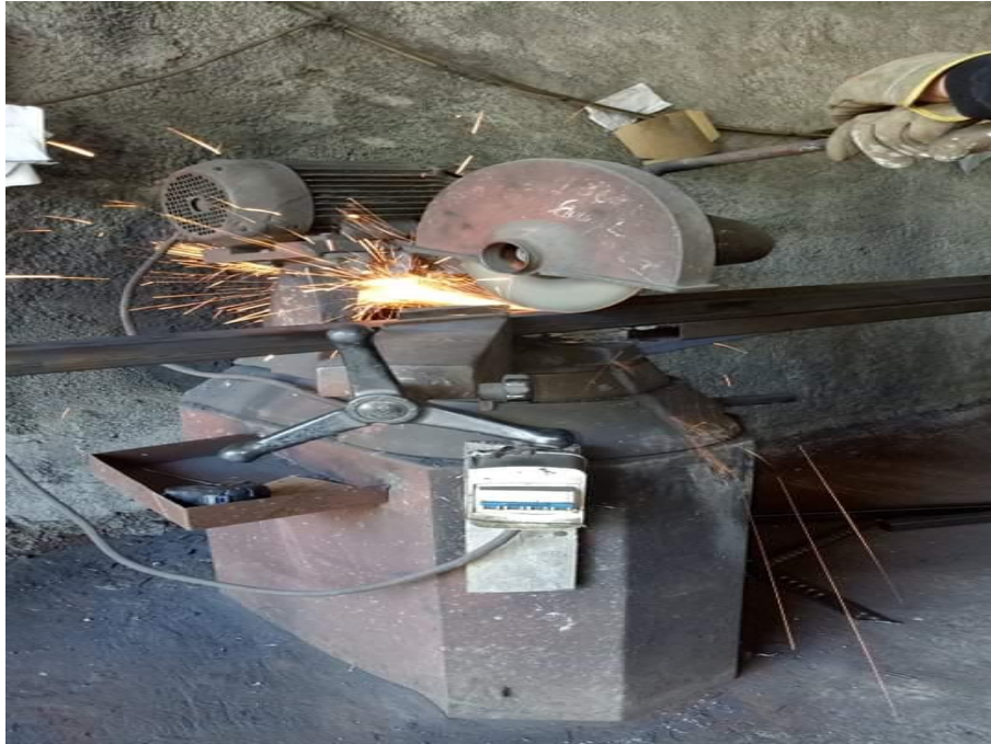
Figure III.18 : Découpage avec scie circulaire «photo prise dans l'atelier »
