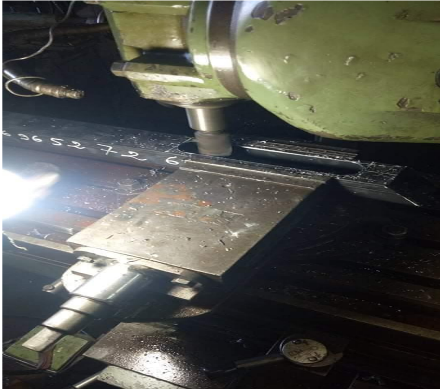
Figure III.21 : Procédé de rainurage réalisé au hall de technologie Oued Aissi
