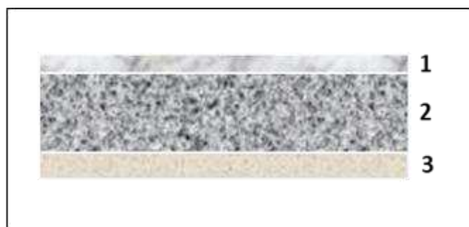
Figure 2.10 : Coupe verticale d'une dalle pleine
