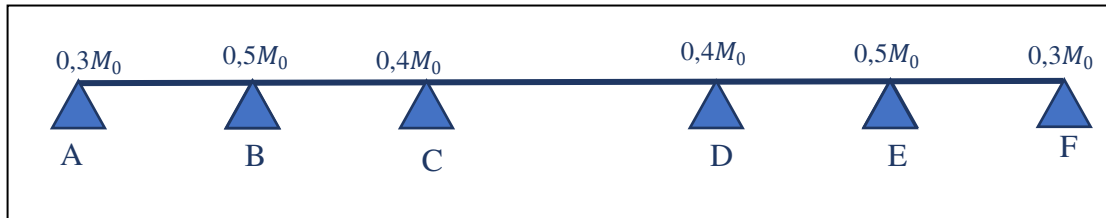
Figure 3.9: coefficients des moments sur appuis poutrelle cas 1
