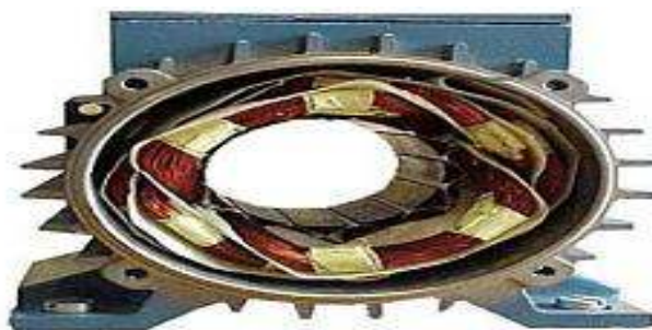
Fig.13.Stator d'une machine asynchrone
