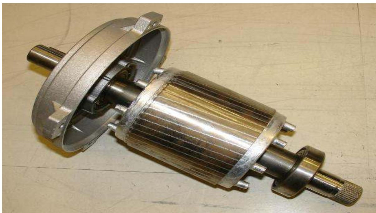
Fig.15.Représentation d'un rotor d'un moteur asynchrone
