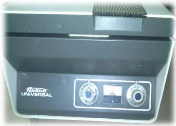
**Centrifugeuse avec ses tubes**
