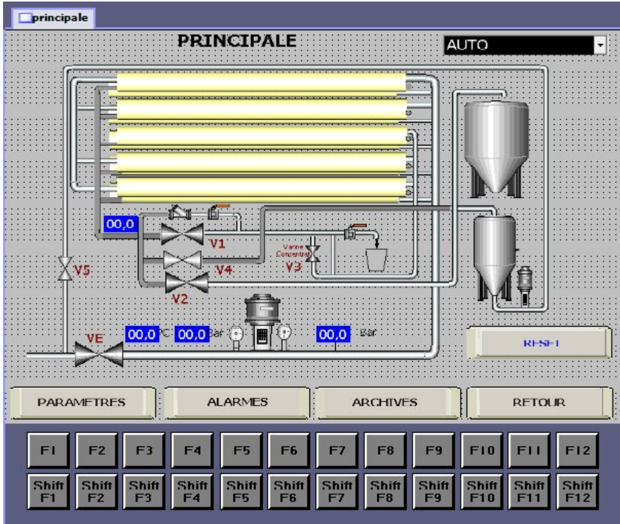
Figure 4.3 la vue principale de l'osmoseur
