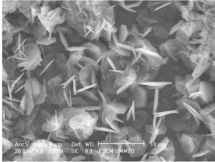
Figure III.8 : Micrographies MEB du cinquième échantillon ( ZnCl_2 avec une concentration de 1 \times 10^{-1} mol/L)
