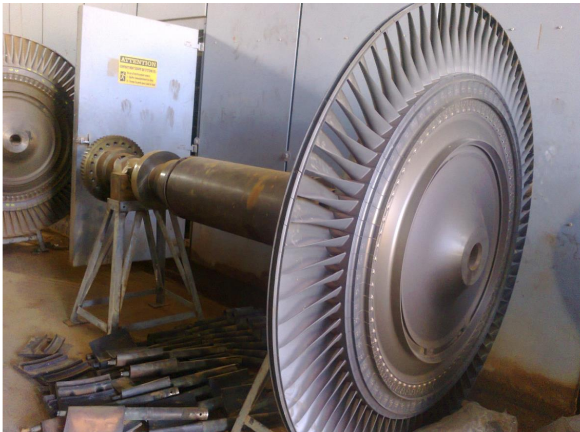
Fig. 22 : Vue du rotor de la turbine basse pression photo prise par moi-même sur le site
