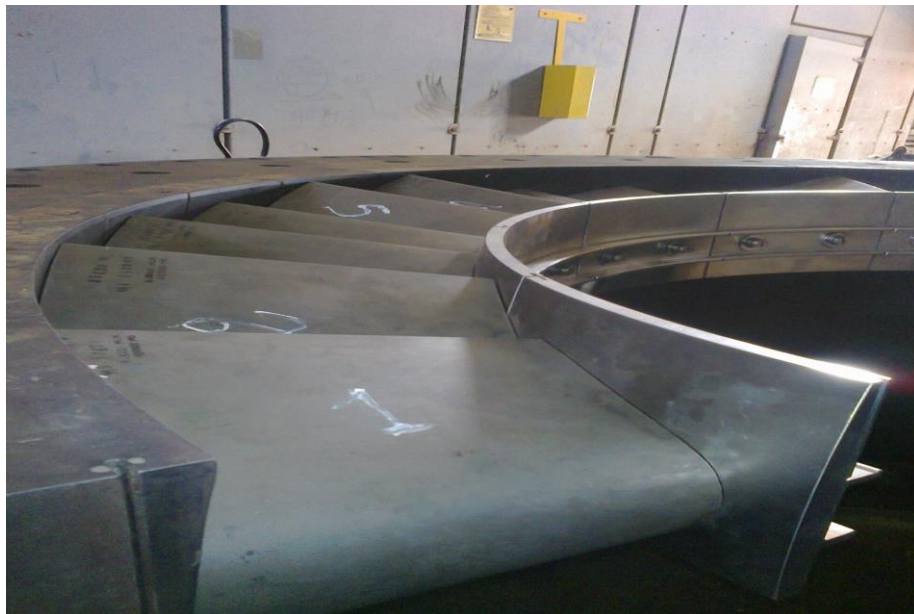
Fig.19 : directrice 1 er étage photo prise par moi-même sur le site
