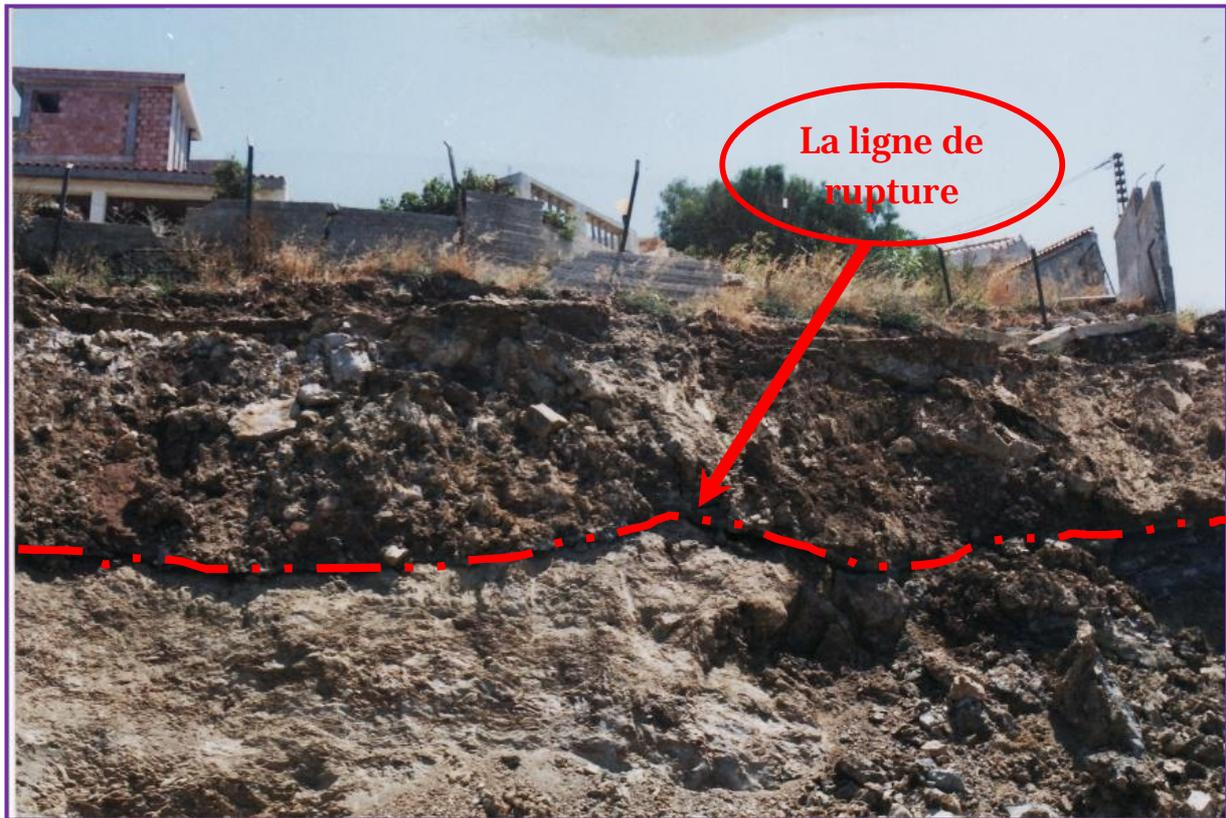
**Figure I- 22: La surface d'interface des deux couches d'éboulis et de marne surface de glissement selon l'étude faite par le laboratoire LNHC EN 2001.**
