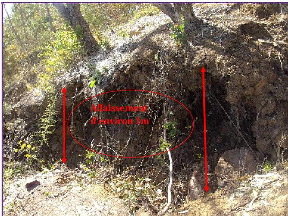
Figure I- 30 : Affaissement d'environ 1 m
