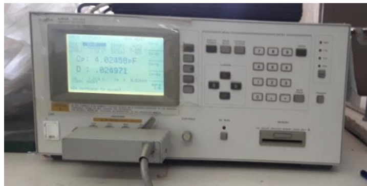
Figure II.6 : Photographie de l'impédance-mètre HP 4284A.
