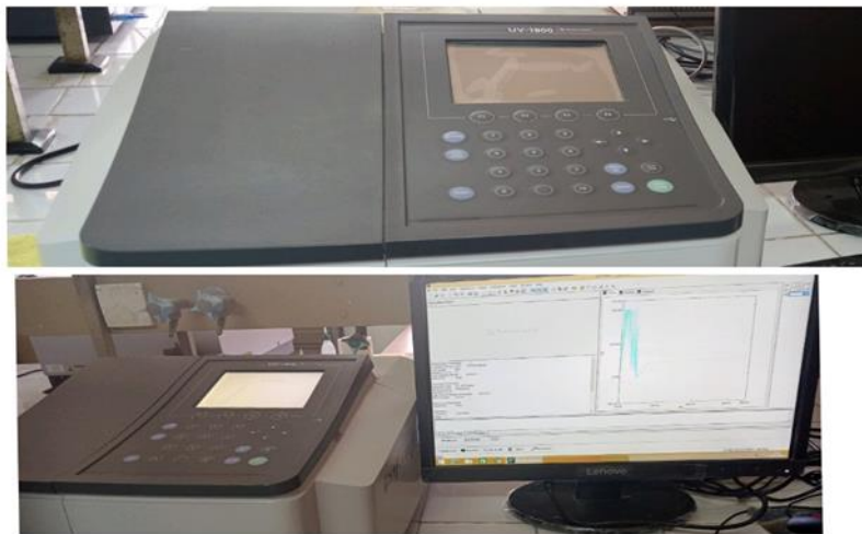
Figure II.4: Spectrophotomètre de type UV1800ENG240V, SOFT.
