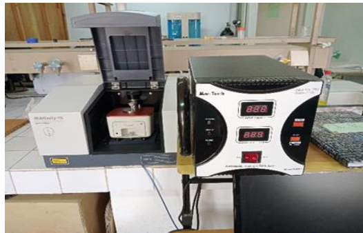
Figure II.5 : Photographie du spectromètre infrarouge à transformée de Fourier IRAffinity-1S.
