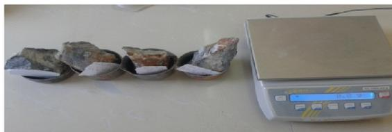
**Figure. III.6 : Échantillons de l'essai de la teneur en eau.**
