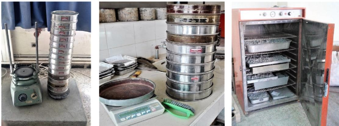
**Figure II.10 : Outillages nécessaires pour l'analyse granulométrique (tamiseuse électrique, Série de tamis, balance, étuve).**
