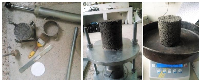
Figure IV.5 : Essai Proctor normal (moule normal).
