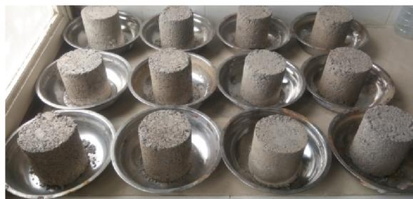
**Figure IV.14 : exemple réalisation des essais Proctor pour une série.**
