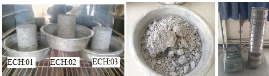
Figure IV.9 : Étapes de déroulement de l'essai (séchage des éprouvettes, concassage, analyse granulométrique).
