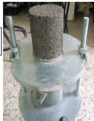
Figure II.3 : Extracteur d'éprouvettes.
