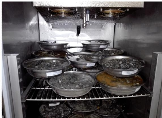
**Figure IV.12 : Mise en place des échantillons dans l'enceinte climatique.**
