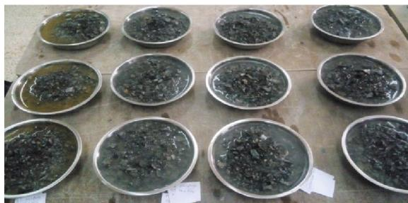
**Figure IV.13 : extraction des échantillons de l'enceinte climatique.**
