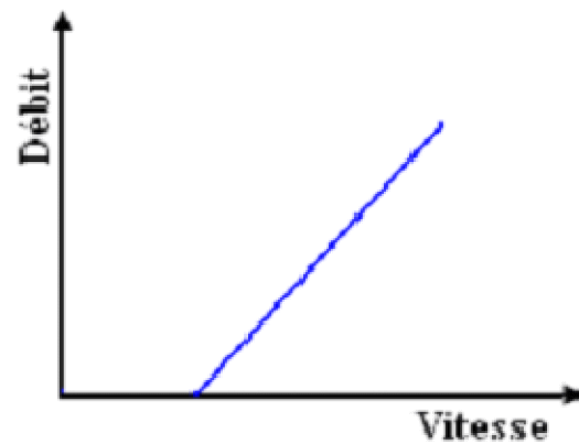
Figure II.3 : Caractéristiques débit-vitesse d'une pompe centrifuge.
