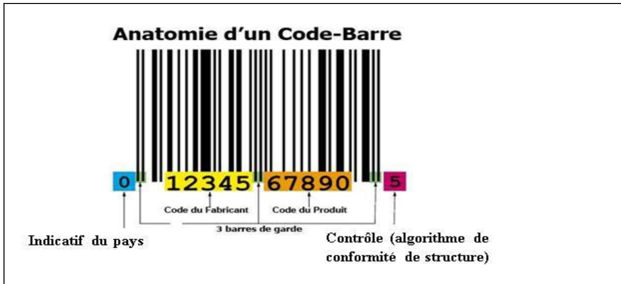
Figure N°4: structure du code-barres
