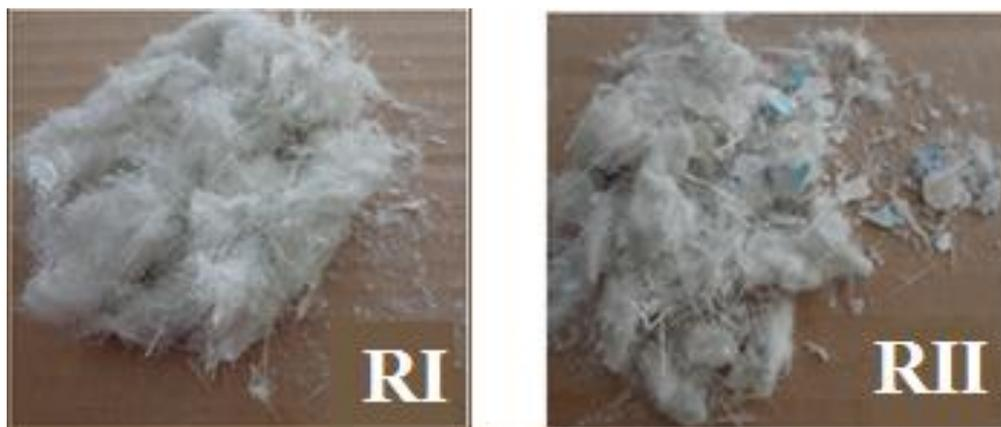
**Fig V.4 :** Recyclé sans gel-coat(RI), Recyclé avec gel-coat(RII)
