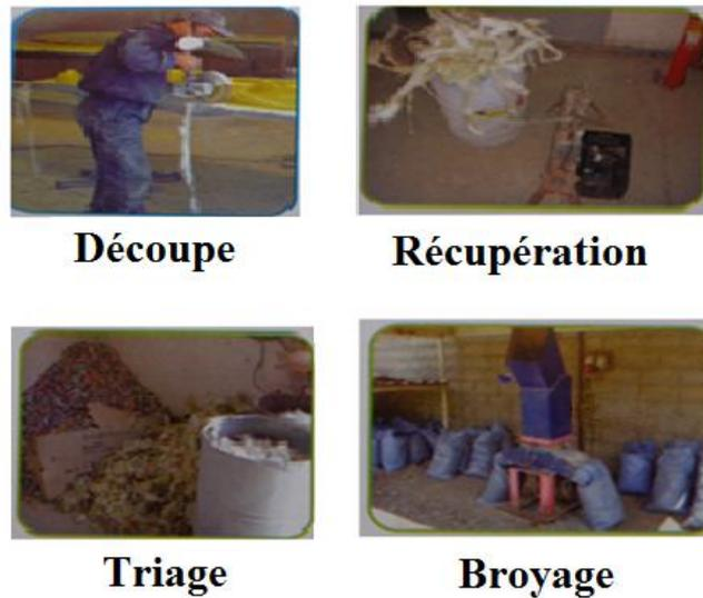
**Fig V.5:** Opérations de : découpe, récupération, triage et broyage des déchets
