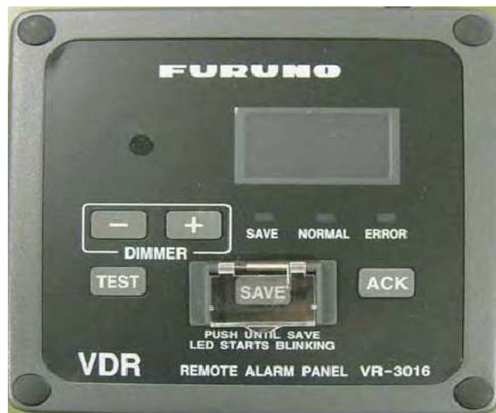
Figure IV.4 : Panneau d'alarmes à distance.
