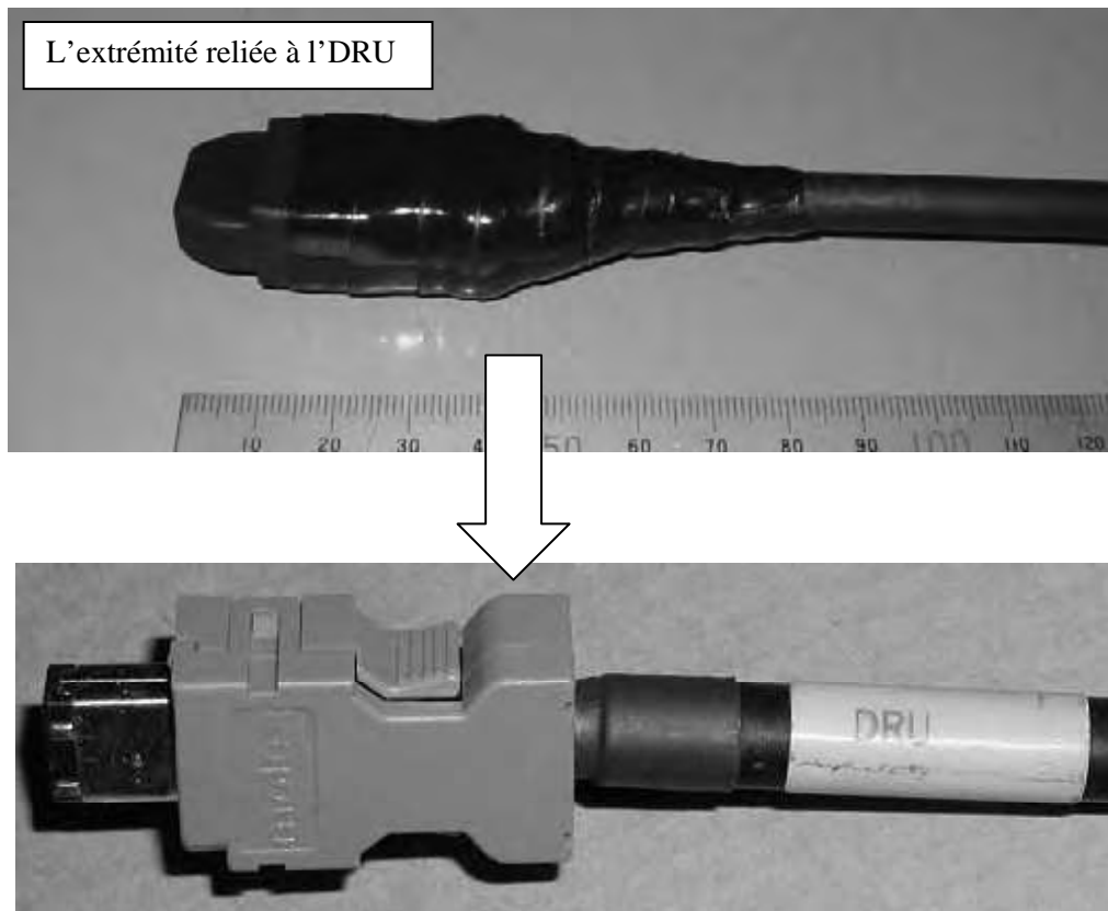
Figure IV.9 : Partie du cable IEEE1394 reliée à DRU.
