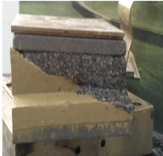
**Figure.14.III:**Echantillon N°13 après cisaillement
