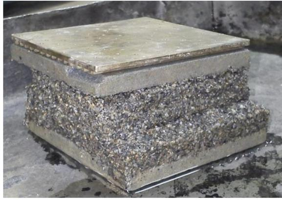
Figure.4. III : Echantillon N°3 après cisaillement.
