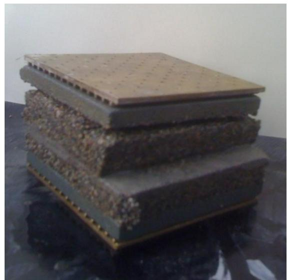
Figure.12.III: Echantillon N°11 après cisaillement.
