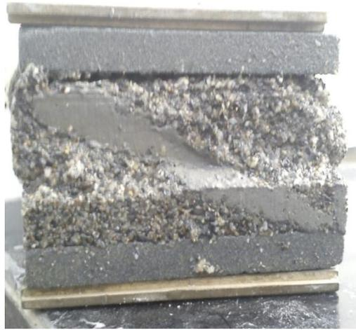
Figure.17. III : Echantillon N°16 après cisaillement.
