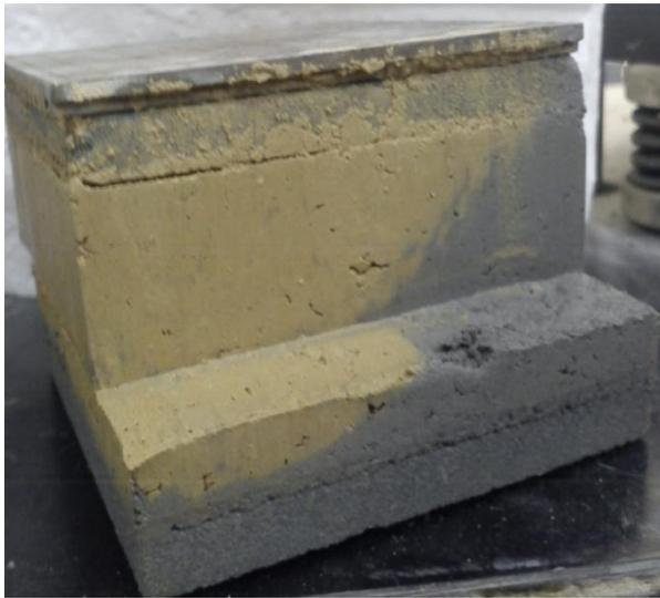
**Figure.13.III:** Echantillon N°12 après cisaillement.
