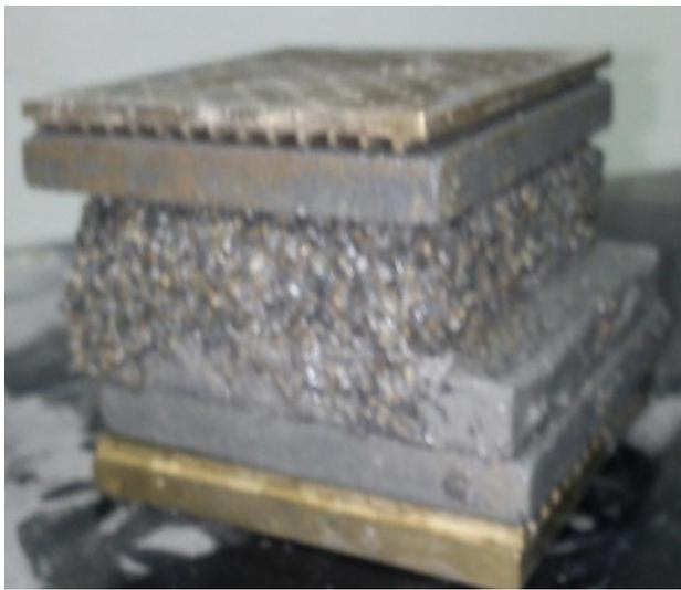
Figure.9. III : Echantillon N°8 après cisaillement.
