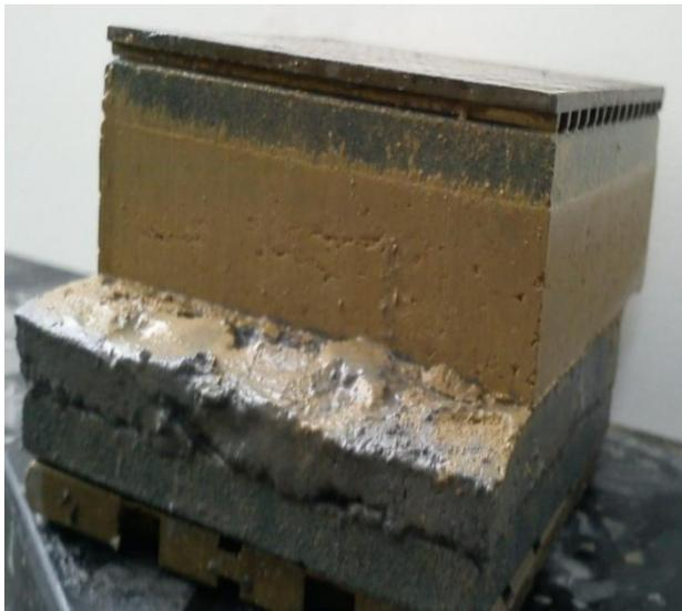
Figure.5.III : Echantillon N°4 après cisaillement.
