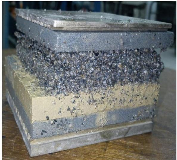
Figure.8. III : Echantillon N°7 après cisaillement.
