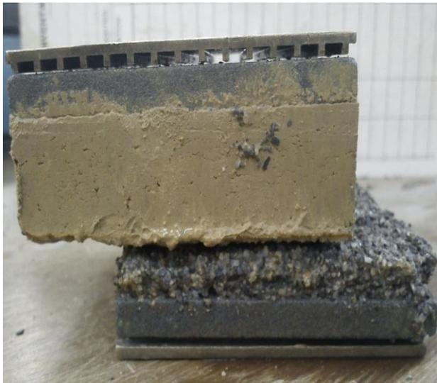
Figure.7. III : Echantillon N°6 après cisaillement.
