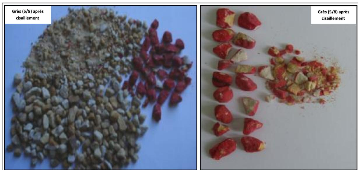
Figure V.6 : Grès (5/8) après cisaillement sous 300 KPa.
