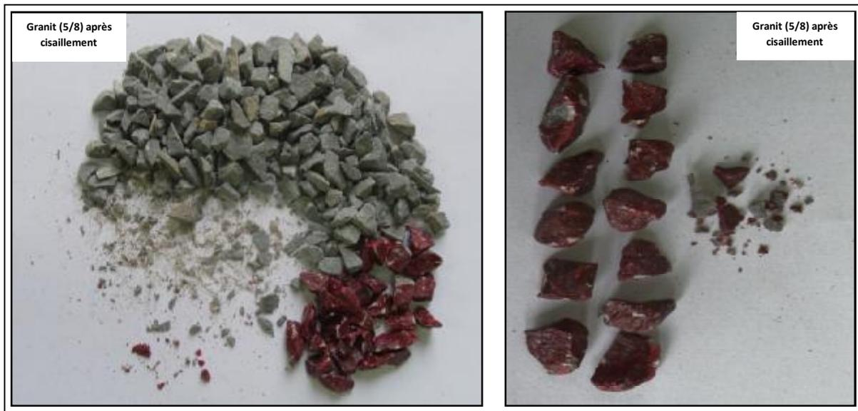
Figure V.4 : Granit (5/8) après cisaillement sous 300 KPa.
