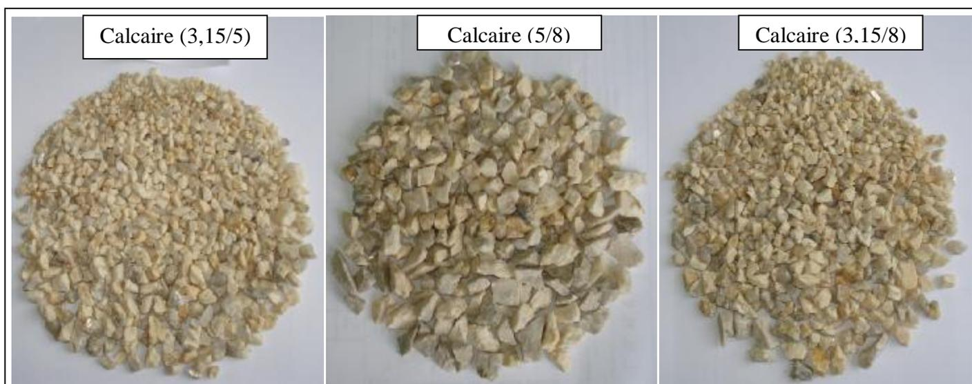
**Figure II.3 : Les échantillons du matériau calcaire utilisés pour cette étude.**
