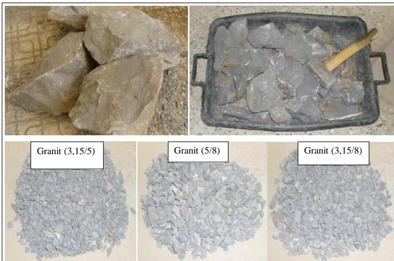
Figure II.1 : Photos du matériau granit et les échantillons utilisés pour cette étude.
