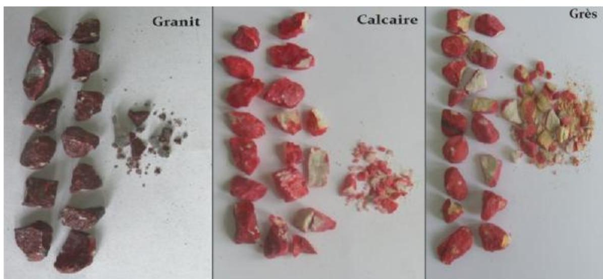
**Figure V.7 : Photos des grains colorés du granit (5/8), du calcaire (5/8) et du grès (5/8) après cisaillement sous 300 kPa.**
