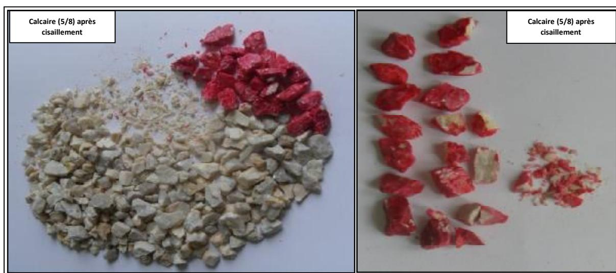
Figure V.2 : Calcaire (5/8) après cisaillement sous 300 KPa.
