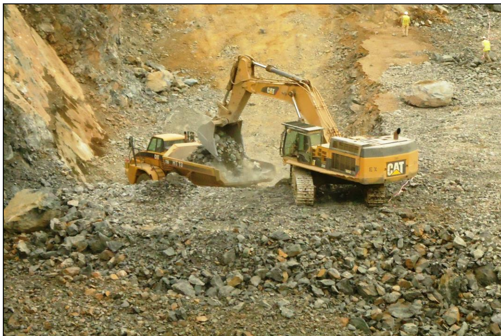
Figure II.7. Chargement du minerai abattu.
