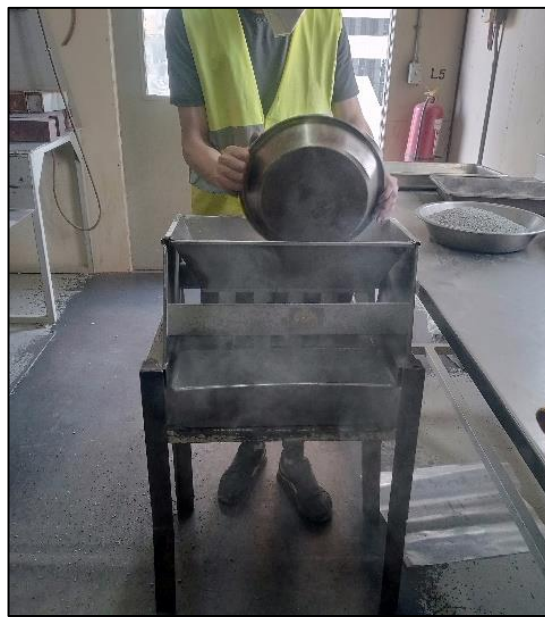
Figure IV.6. Homogénéisation du minerai concassé par le diviseur à riffle.
