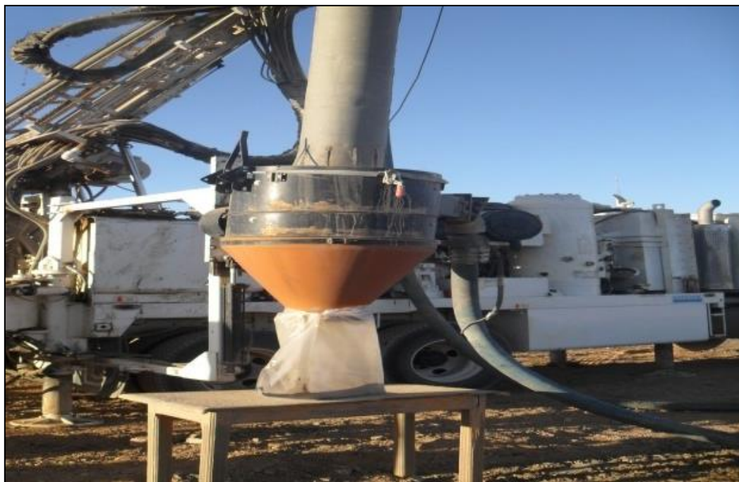
Figure II.2. Echantillon obtenu après sondage. [25]
