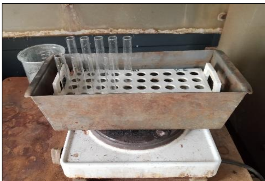
Figure IV.16. Tubes contenant les perles et \text{HNO}_3 dans un Bain-marie.
