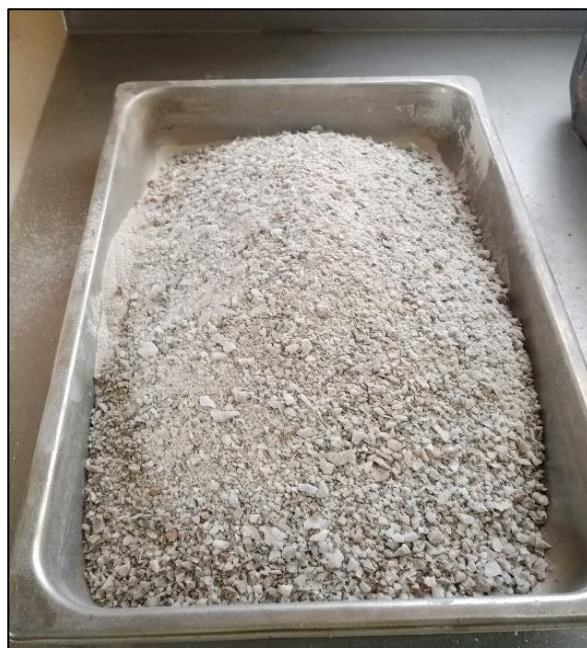
Figure IV.4. Minerai concassé (<4mm).
