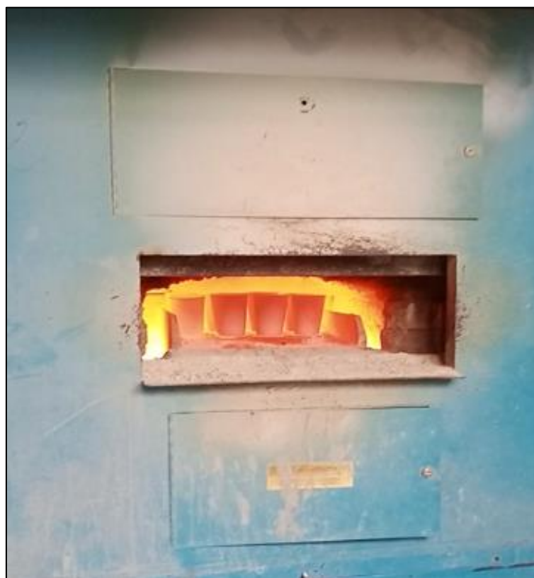
Annexe II.12. Creusets dans le four préchauffé à 1050°C.
