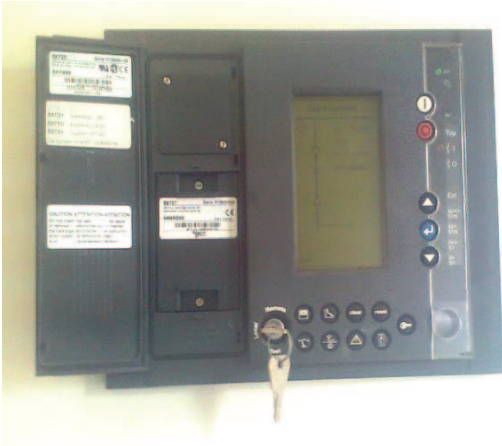
Figure 1 : Vue face avant du SEPAM
