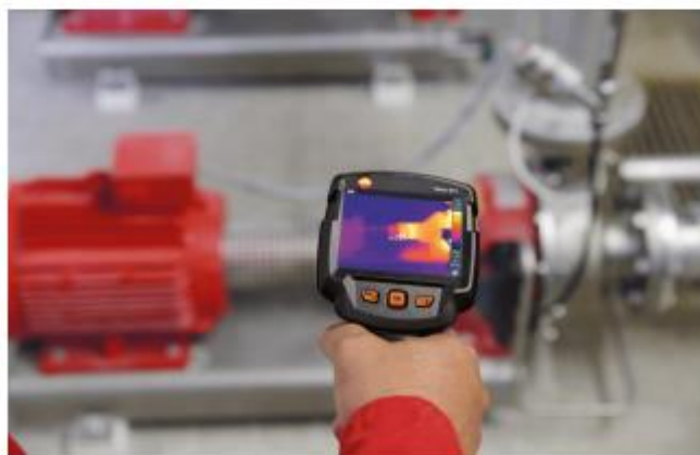
Figure 6: Principe du CND par Thermographie
