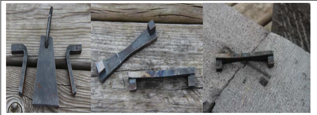
الصورة رقم 29: صورة لقضبان معدنية للربط والرفع.
