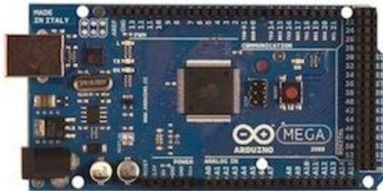
Figure 39: La carte Arduino Mega 2560
