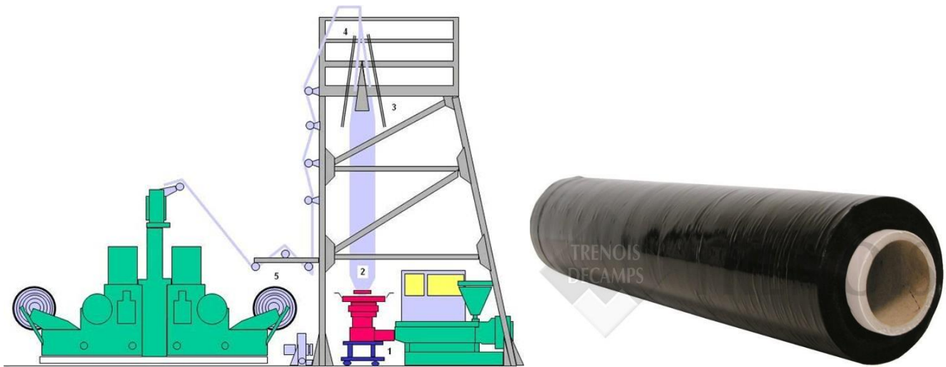
Fig. (II. 8) : Procédé extrusion gonflage.
