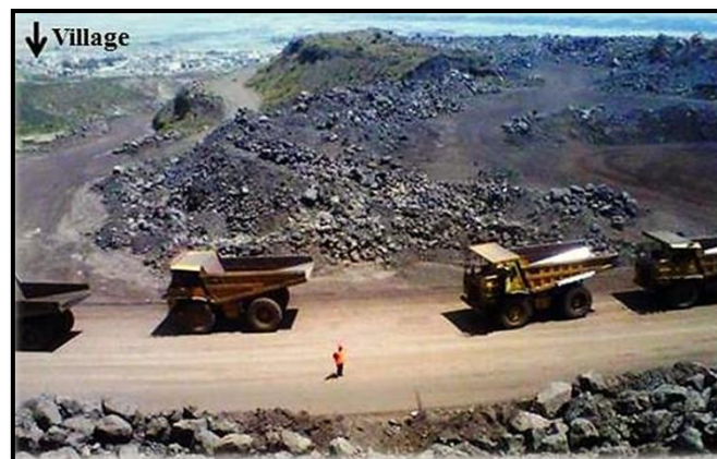
Fig.62: Camions à moteur diesel utilisés pour le transport du minerai dans la mine.
