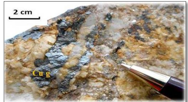
Fig. 27 : Filonnet rempli par du cuivre gris.
