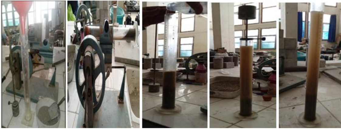
Figure II.A.14 : L'essai d'équivalent du sable.
