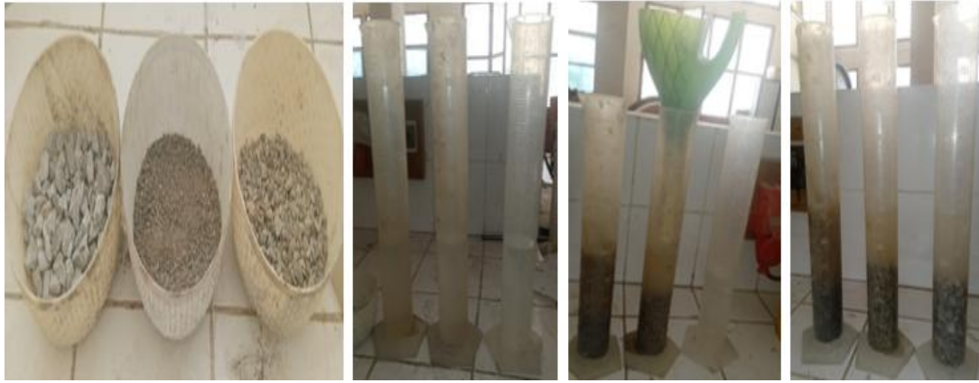
Figure II.A.12 : Mesure de la masse volumique absolue des graviers.
