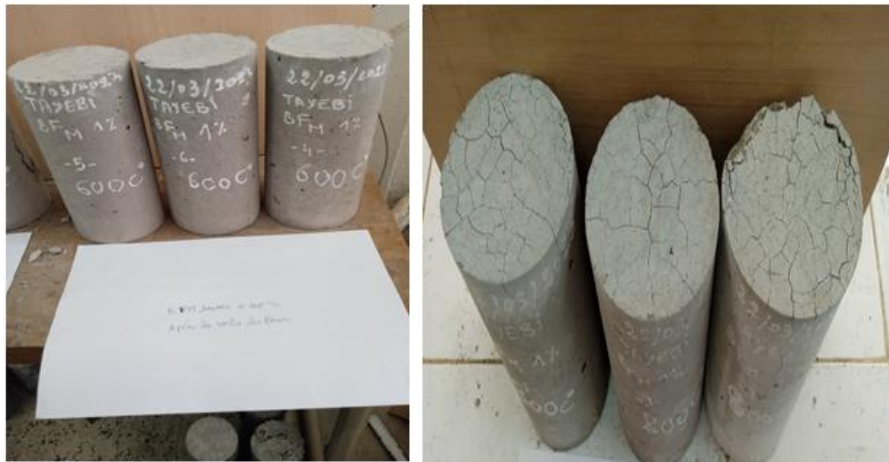
Figure II.B.12 : L'aspect des éprouvettes cylindriques du béton de fibres métalliques (BFM) à la sortie du four (600°C et 800°C).
