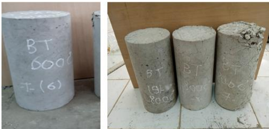
Figure II.B.11 : L'aspect des éprouvettes cylindriques du béton témoin (BT) à la sortie du four (600°C et 800°C).
