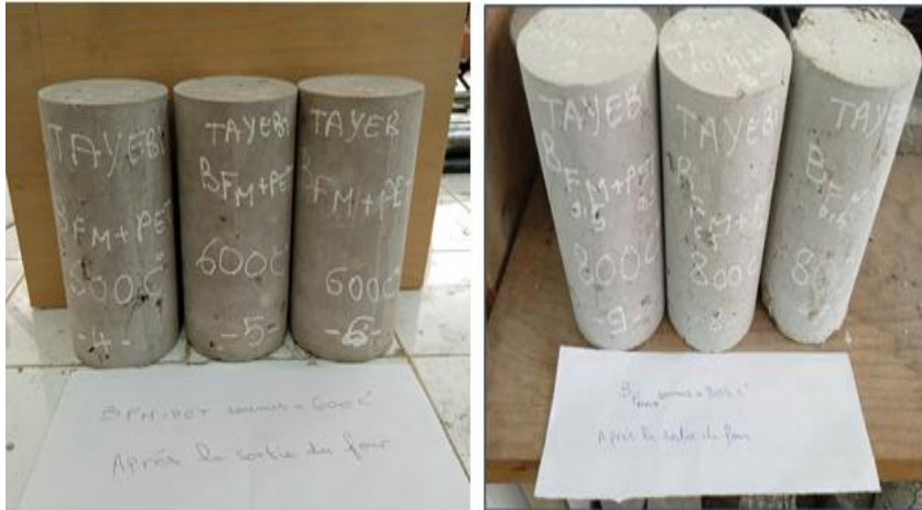
Figure II.B.14 : L'aspect des éprouvettes cylindriques du béton de fibres cocktail (BFMP) à la sortie du four (600°C et 800°C).
