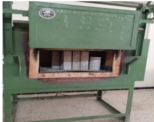
Figure II.A.21 : Disposition des éprouvettes à l'intérieur du four.
