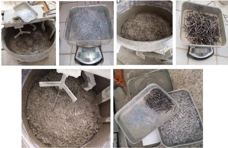
Figure II.A.17 : Le gâchage des bétons.
