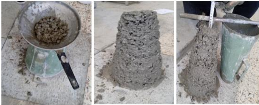
Figure II.A.15 : Détermination d'affaissement du béton l'état frais.
