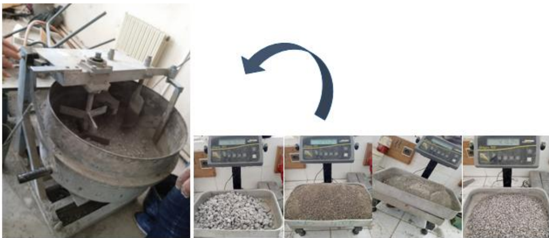
Figure II.A.16 : Déversement des matériaux secs dans le malaxeur.
