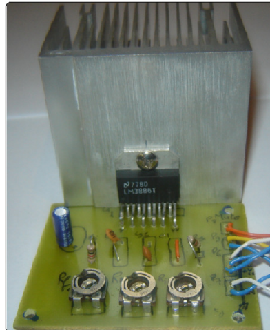
Figure IV.11 : Carte de l'amplificateur en puissance monté sur son radiateur.
