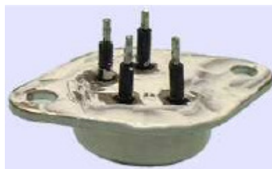
Figure IV.4 : Chaque broche du composant est protégée par de la gaine thermorétractable sur l'épaisseur du radiateur. Il est enduit de pâte thermique pour améliorer la transmission de la chaleur avec le radiateur.
