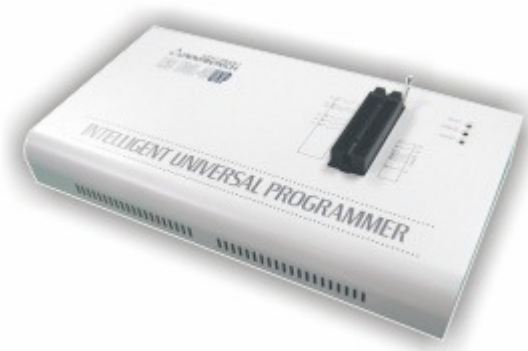
Figure IV.3: Programmeur universel professionnel.
