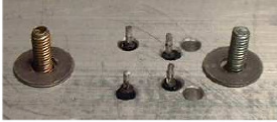
Figure IV.5 : Le composant est monté sur son radiateur. Deux rondelles de 3 mm sont insérées entre le circuit imprimé et le radiateur (augmentation de la surface de contact avec l'air).
