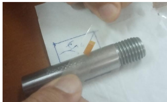
Figure 4.4 : collage des jauges [15]
