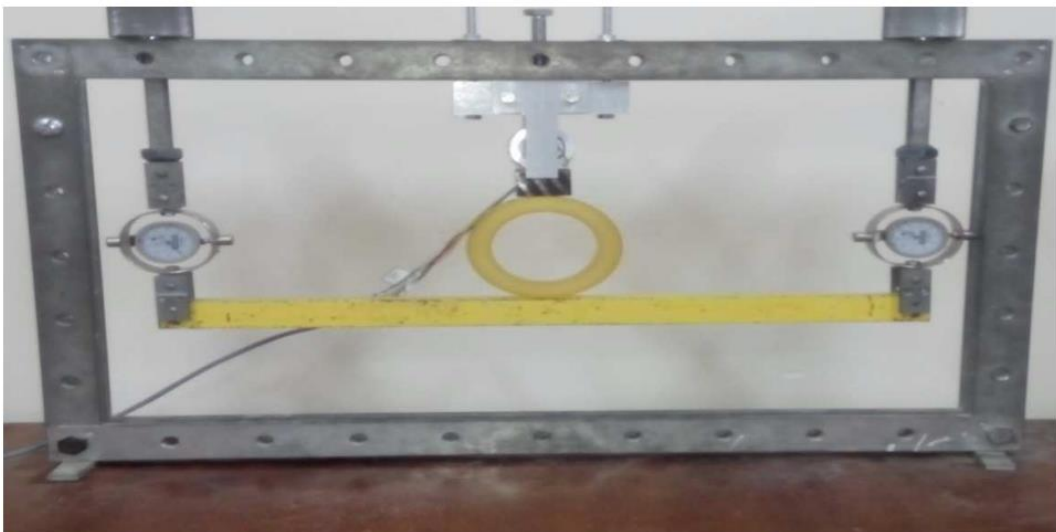
Figure 4.6 : étalonnage du capteur [15]
