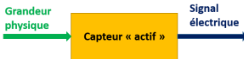
Figure 3.5: fonctionnement d'un capteur actif [9]
