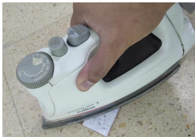
Figure 4.30 : transfert du typon à l'aide d'un fer à repasser
