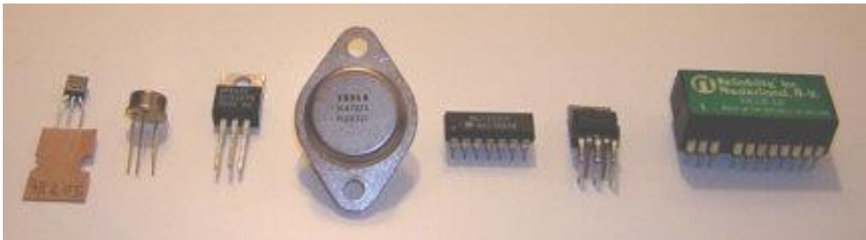
Figure 2.23 : différents types de régulateur de tension. [8]
