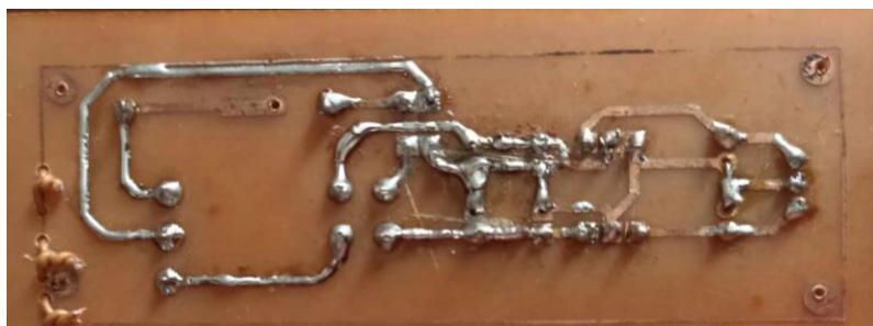
Figure 4.37 : plaque après soudage de tous les composants
