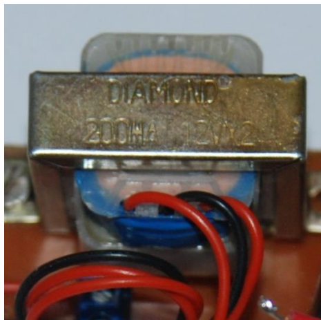
Figure 4.11 : transformateur a point milieu utilisé dans notre alimentation
