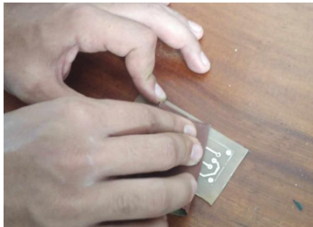
Figure 4.36 : frottage de la surface avec du papier vert fin avant soudage.
