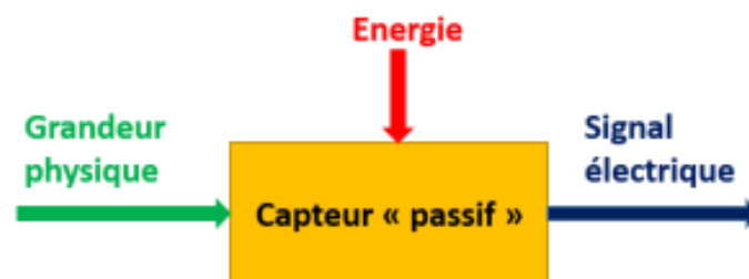
Figure 3.10 : fonctionnement d'un capteur passif [10]
