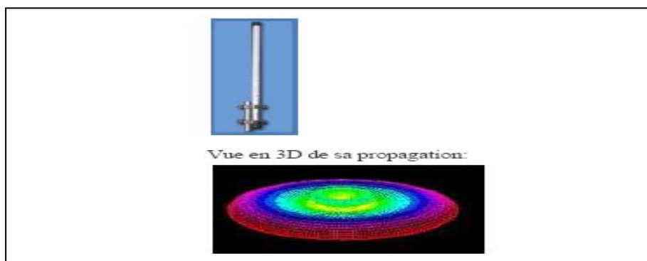
Figure II.13« Exemple d'une antenne omnidirectionnelle »
