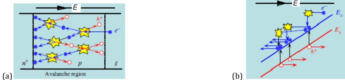
Figure III-53 : (a): Processus d'ionisation d'impact pour générer des paires électron-trou et la multiplication par l'effet avalanche. (b) : Impact d'un électron de la conduction avec les vibrations du cristal transfère l'énergie cinétique de l'électron à un électron de la valence et de cette façon il l'excite au bande de la conduction.-
