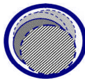
b) Excentricité dynamique (plusieurs position du rotor au cours de la rotation)
