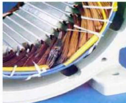
d) Dégradation causée par une surtension
