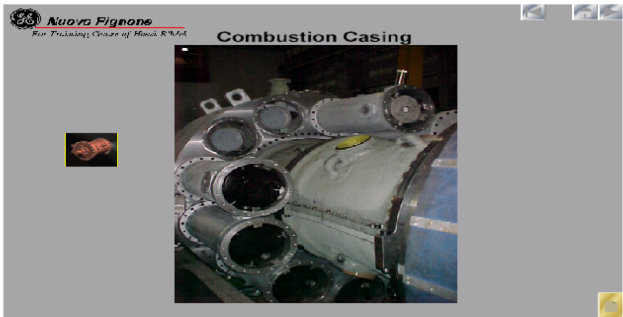
Figure II.3 : les chambres de combustion
