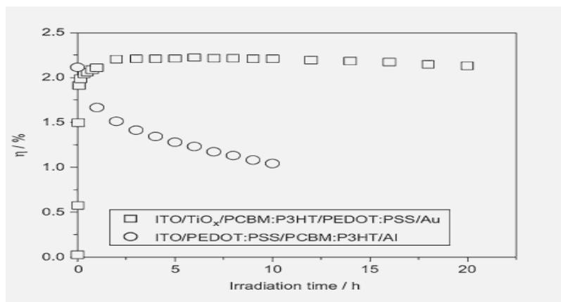
Figure 4-2 : La variation de PCE du dispositif inverse (les carreaux) et dispositif conventionnel (les cercles) exposés à l'air [69].
