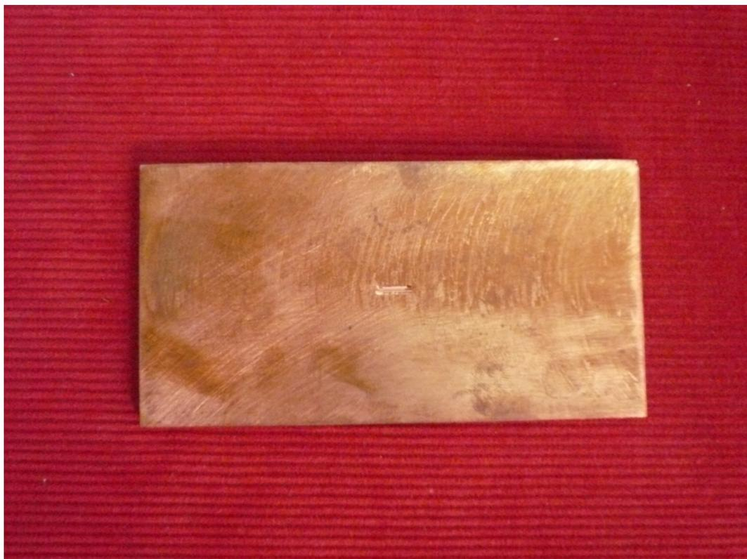
Figure IV.16 : Plaque en cuivre avec défaut
