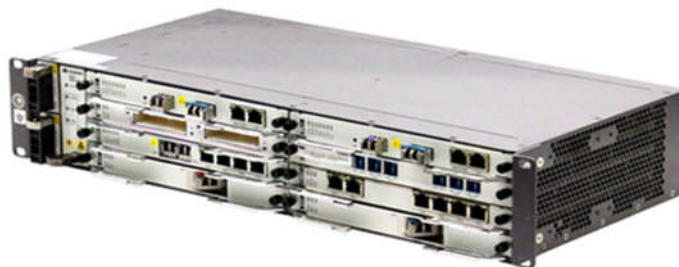
Figure 56 : Structure de l'équipement OptiX OSN 550.
