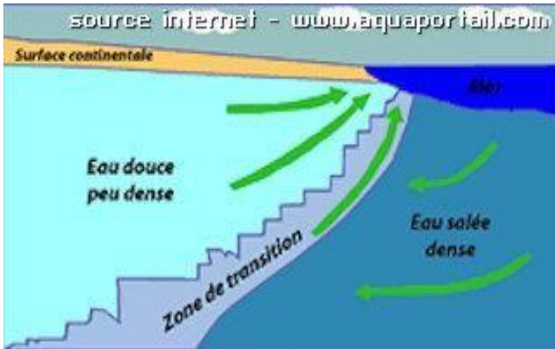
Figure 4.21:Schéma indique le biseau salé (ou intrusion d'eau salée) par les flèches vertes (Google)
