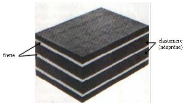
Figure X.2 : appareil d'appui en élastomère fretté.
