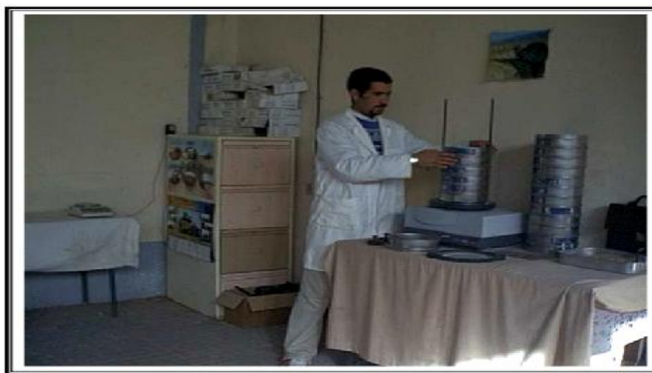
Figure (IV.13) : Conduite de l'essai granulométrique du sable.
