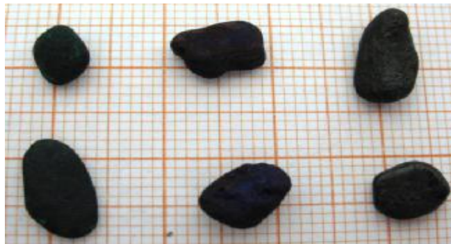
Figure (IV.10) : Photographie des grains de sable de rivière dont la forme est sous arrondie.
