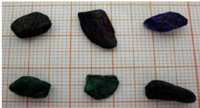
Figure (IV.11) : Photographie des grains de sable de rivière dont la forme est sous angulaire.
