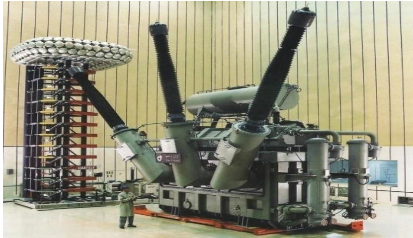
Figure I.1 : Transformateur de puissance
