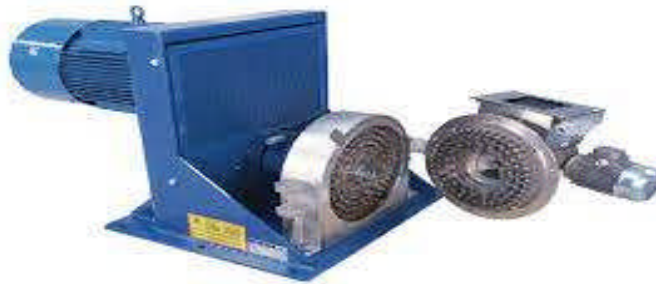
Figure 15: Broyeurs métalliques (Anonyme 2017).
