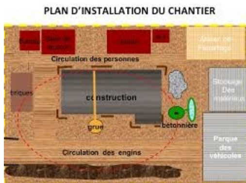
Figure 17: Exemple d'un plan d'installation de chantier [1]
