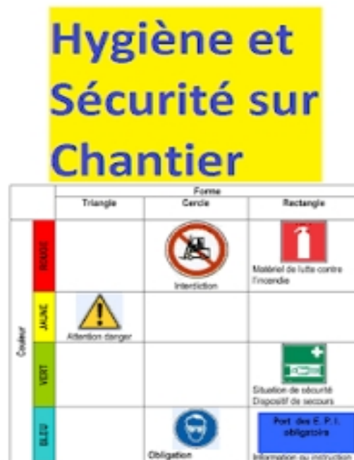
Figure 14 : étiquette d'hygiène et sécurité aux chantiers [1]
