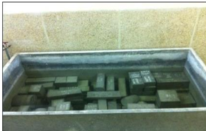
Figure V.12 : immersion des éprouvettes dans le bac d'eau
