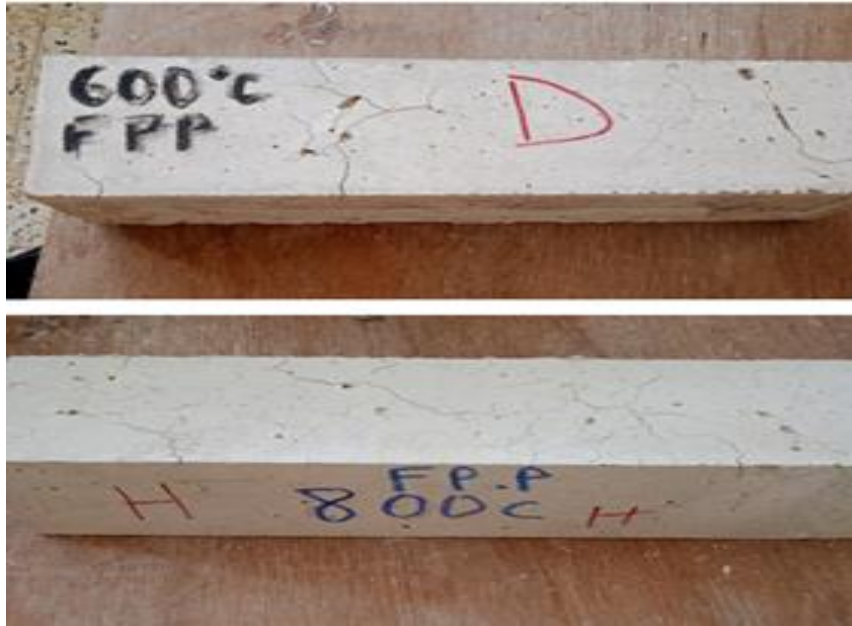
Figure (IV.18) : L'aspect des éprouvettes prismatiques du béton de fibres de polypropylène à la sortie du four.
