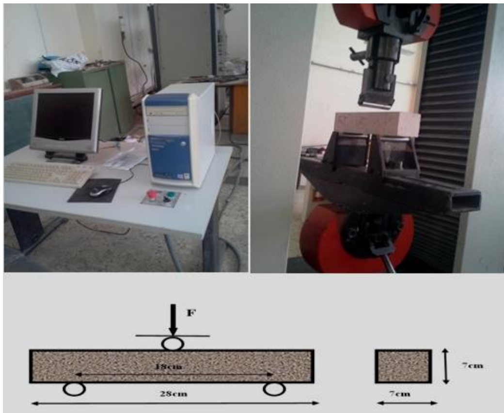
Figure III.15 :Dispositif expérimental pour l'essai de traction par flexion 3 points.
