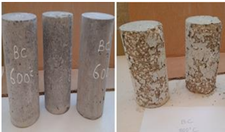
Figure (IV.11) : L'aspect des éprouvettes cylindriques du béton de fibres cocktail à la sortie du four.
