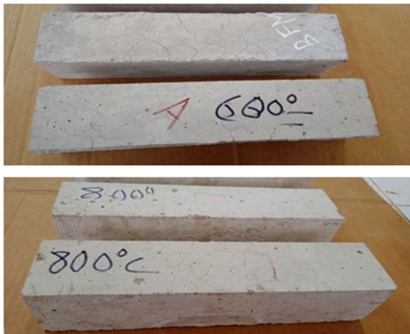
Figure (IV.19) : L'aspect des éprouvettes prismatiques du béton de fibres métalliques à la sortie du four.
