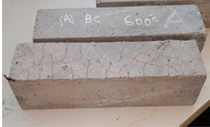
Figure (IV.20) : L'aspect des éprouvettes prismatiques du béton de fibres cocktail à la sortie du four.
