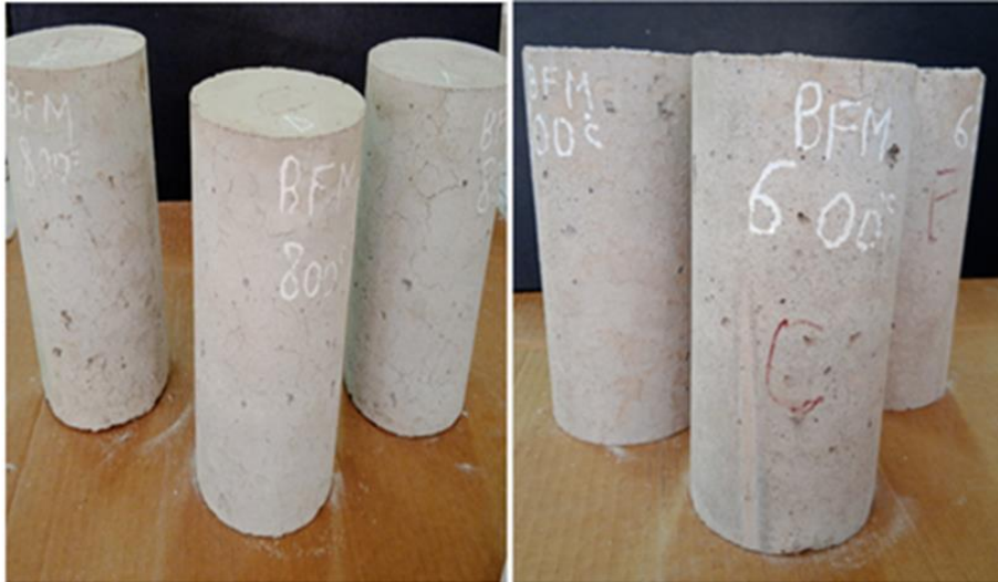
Figure (IV.10) : L'aspect des éprouvettes cylindriques du béton de fibres métalliques à la sortie du four.
