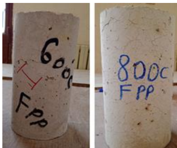
Figure (IV.9) : L'aspect des éprouvettes cylindriques du béton de fibres de polypropylène à la sortie du four.
