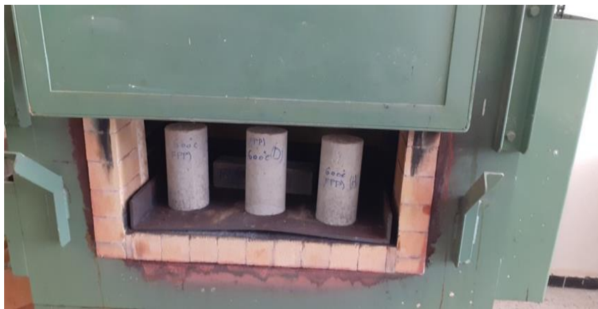
Figure III.11 : Disposition des éprouvettes à l'intérieur du four.
