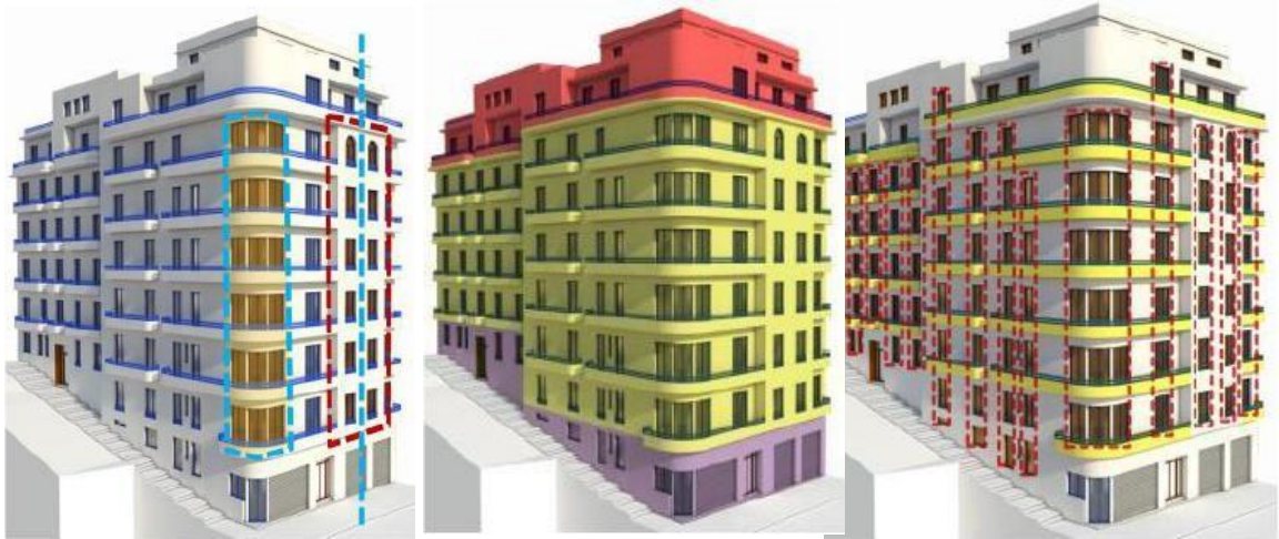
Figure 22 :représentation des caractéristiques de l'architecture rationnelle sur la façade du bâtiment voisin au site : rythme, tripartite, symétrie Source : mémoire fin d'étude, l'immeuble 5 : créateur de synergie
